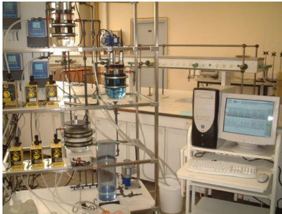
Exemple : Système spécifique d'analyse multi-mesures et de supervision (pompes, procédé) pour un réacteur-pilote de traitement de déchets industriels.
