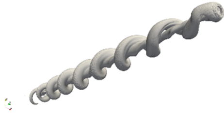
Figure 2 : Bulle ascendante suivant une trajectoire en forme de spirale
