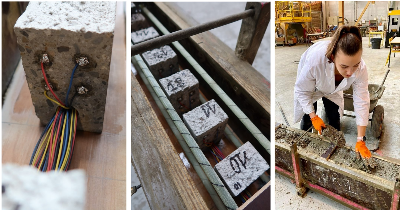
Fabrication d'une poutre en béton armé instrumentée
