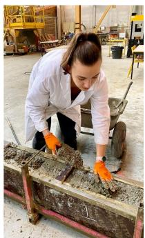
Fabrication d'une poutre en béton armé instrumentée
