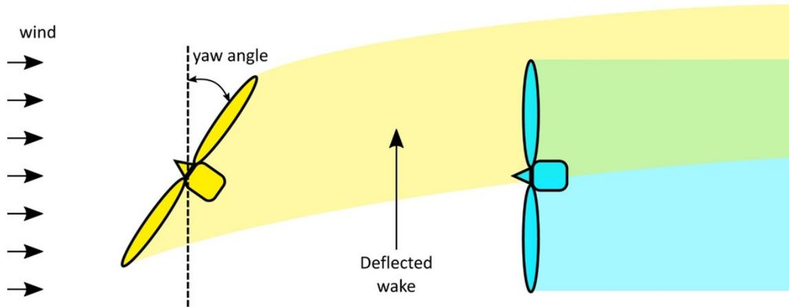
Figure 2: Réorientation de sillage avec contrôle de lacet
