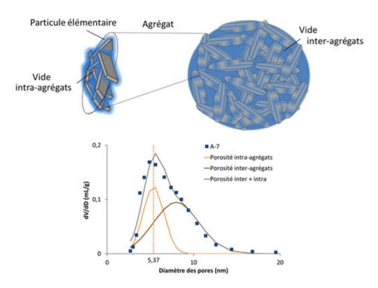
Figure 2 : en haut, la représentation des volumes intra- et inter-agrégats ; en bas, la déconvolution de la répartition poreuse obtenue par physisorption d'azote en deux populations de pores représentant ces deux volume inter- et intra-agrégats.
