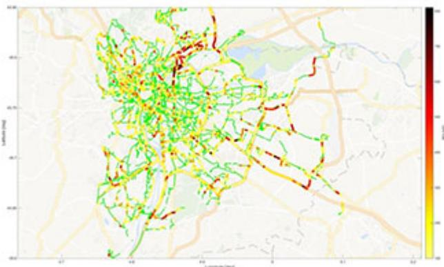
*Cartographie des émissions d'oxydes d'azote autour du Grand Lyon construite grâce à l'aide des utilisateurs de **Geco air**.*
