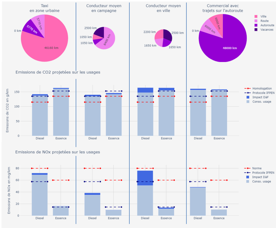
Figure 30 : Comparaison des émissions de CO2 et de NOx projetées sur les usages pour les véhicules SUV compact DV3 / GV3
